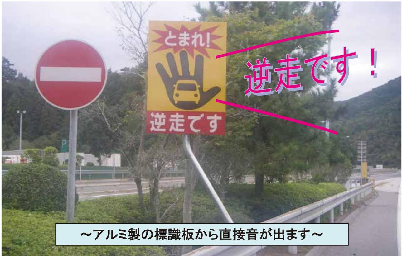
~アルミ製の標識板から直接音が出ます~
