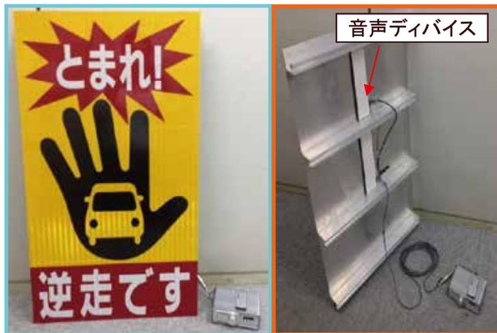
音声デバイスの活用方法は多用途です。例えば、ガードレールからも音声は出せますし、また、手摺なども端末にデバイスを取付けるだけで延長30m程度なら手摺全体からクリアな音が出せたりします。高速道路の入口、出口で歩行者・自転車の誤進入対策として設計しましたが、センサーと組み合わせる事でより大きな効果が期待できます。センサー設計、ソーラー式、24時間対応のソーラー式など、設計・製作・販売まで何でもお問い合わせください。
